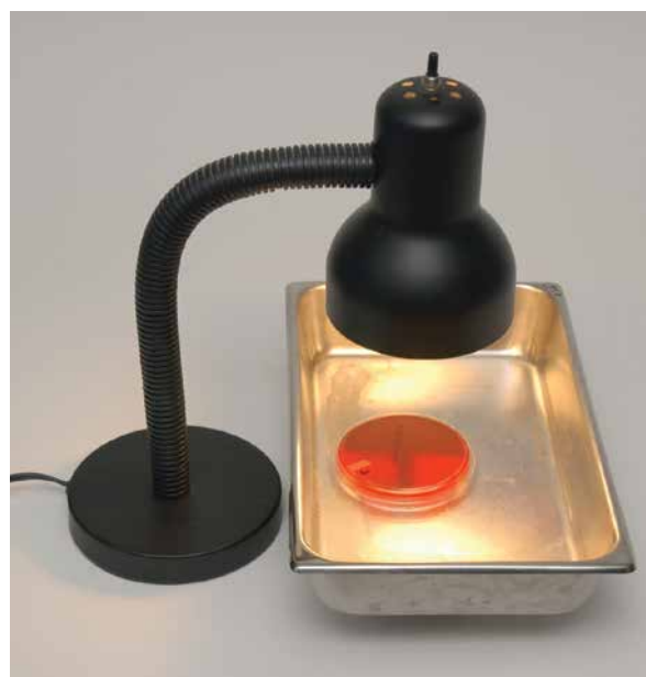
Figura 9.2 Incubación de una placa con agar sangre mediante una lámpara incandescente de 60 vatios; así, se mantiene la temperatura de la superficie en 38 °C.
